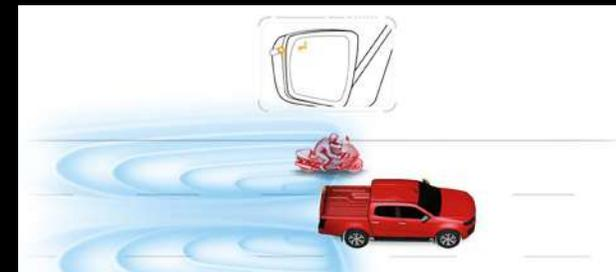
**BSM (Blind Spot Monitoring).** Das BSM-System überwacht den toten Winkel und warnt den Fahrer vor Fahrzeugen, die in den Seitenspiegeln nicht sichtbar sind.
