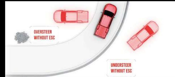
**ESC (Electronic Stability Control).** Das ESC-System überwacht die Fahrzeugstabilität ununterbrochen und greift automatisch ein, indem es einzelne Räder abbremst oder die Motorleistung reduziert, um ein Unter- oder Übersteuern zu verhindern, sodass der Fahrer die Kontrolle über das Fahrzeug in Notsituationen oder auf glatten Strassen nicht verliert.
