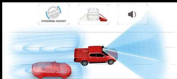
**ELK (Emergency Lane Keeping).** Das ELK-System greift ein, damit das Fahrzeug in Notsituationen in der Fahrspur bleibt und dient daher zum Vorbeugen von Unfällen durch unbeabsichtigtes Verlassen der Fahrspur.
